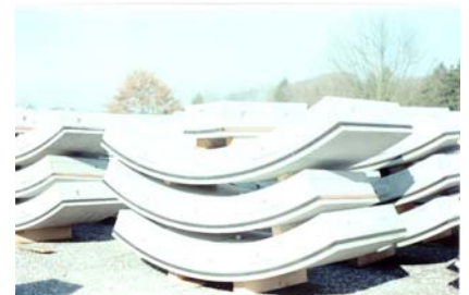
Bereits schon auf Werkslagerplatz fixfertig für Einbau gestapelt
